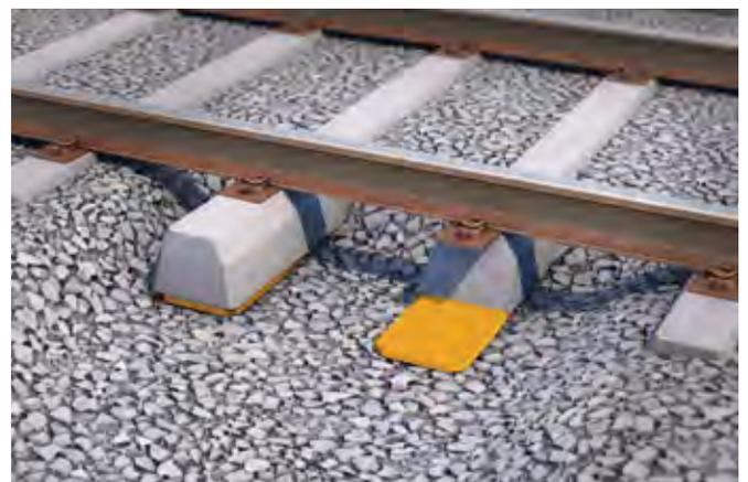
Illustration Schwellensohle Querschnitt
