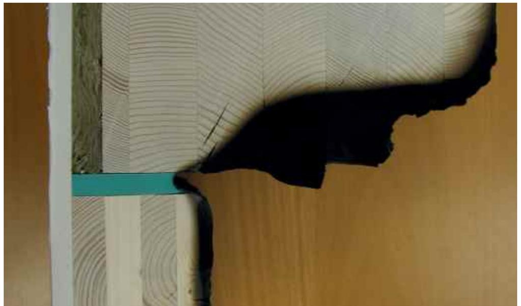
Abb. 7: Anschlussdetail nach 60 Minuten Brandlast
