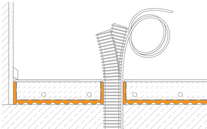
Abb.1: Ausführungsdetail mit beheiztem Nassestrich
