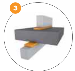
Trennung angrenzender Bauteile (Flankenschall)
