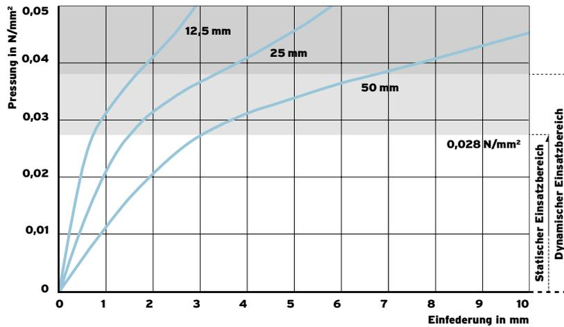
Abb. 1: Quasistatische Federkennlinie für verschiedene Lagerdicken
