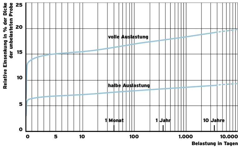
Abb. 4: Verformung unter statischer Belastung in Abhängigkeit der Zeit
