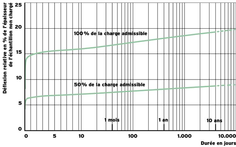
Fig. 4 : Augmentation de la déflexion sous charge constante
