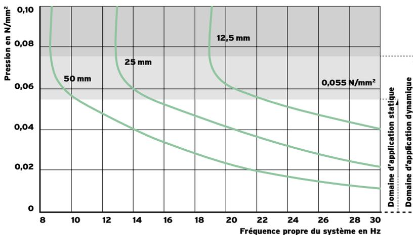
Fig. 3 : Fréquence propre pour différentes épaisseurs d'appui
