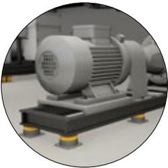
Di norma le pompe trasportano liquidi che possono presentare viscosità diverse. A seconda del tipo di sostanza, della pressione e della distanza può essere necessario un ampio isolamento contro le vibrazioni meccaniche.
