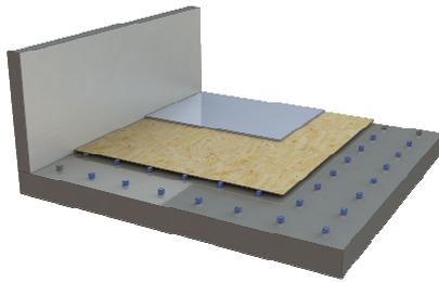
**6a)** Bei der Verlegung von mehreren Lagen Trockenestrich ist darauf zu achten, die Stöße entsprechend versetzt (min.  $a/2$ ) anzuordnen.
