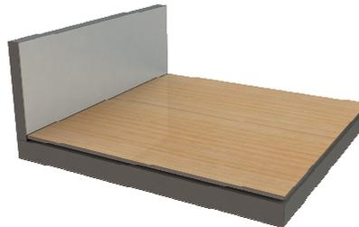
**9)** Überstehende Teile der PE-Folie und des Randdämmstreifens erst nach fertiger Verlegung des Fertigfußbodens abschneiden.
