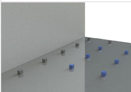
**4a)** Positionierung der Floor Block Typen nach dem Verlegeplan auf dem Untergrund.
