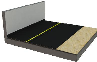
**6b)** Bei gegossenen Estrichen sind im Vorfeld Randdämmstreifen an allen aufgehenden Bauteilen anzubringen. PE Folie (0,2 mm) auf der verlorenen Schalung auslegen. Stöße 20 cm überlappen und an aufgehenden Bauteilen hochziehen. Stöße mit geeignetem Klebeband verkleben.
