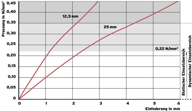
Abb. 1: Quasistatische Federkennlinie für verschiedene Lagerdicken
