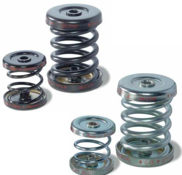
Le molle in acciaio come elementi di isolamento delle vibrazioni offrono numerosi vantaggi, che possono migliorare significativamente sia le prestazioni che l'affidabilità dei dispositivi isolati. Grazie alla loro bassa frequenza naturale, le molle in acciaio offrono eccellenti proprietà di isolamento e sono particolarmente adatte a macchine come ventole o ventilatori che presentano frequenze di disturbo basse.
